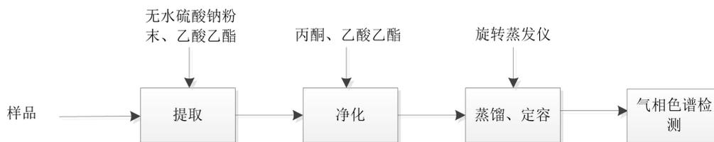
图 2.3-10 样品中有机磷农药检测实验工艺流程
